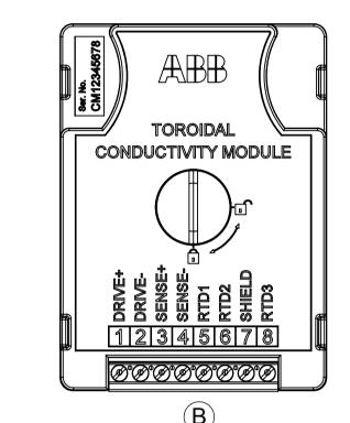
**OUTPUT PARAMETERS - TOROIDAL** Voc(Uo) = 11.8VIsc(lo) = 11.8mAPo = 36mW Ca(Co) = 1.5uFLa = 1H
