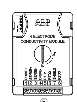
**OUTPUT PARAMETERS - 4 ELECTRODE** Voc(Uo) = 11.8VIsc(lo) = 11.8mAPo = 36mW Ca(Co) = 1.5uF
