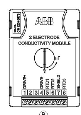
**OUTPUT PARAMETERS - 2 ELECTRODE** Voc(Uo) = 11.8Vlsc(lo) = 11.8mAPo`= 36mW
