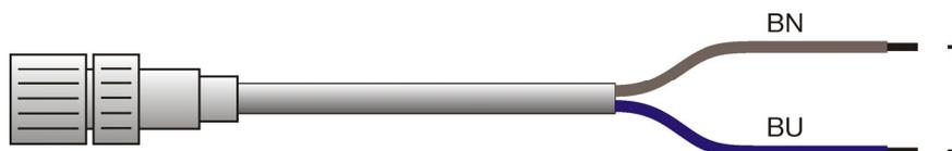
El receptáculo en uno de los extremos del cable está diseñado para conectarse al enchufe macho de 24 VCC del módulo de análisis.
