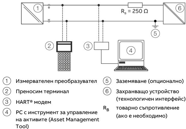
Фигура 13: Пример за свързване HART
