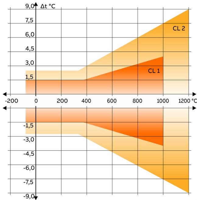
Figura 4: Representación gráfica de las clases de precisión, ejemplo para tipo K y N conforme a IEC 60584. Consultar otros tipos en las tablas.
