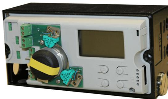
Figura 7: TZIDC abierto, vista del panel de control
