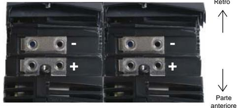
2. Collegare i busbar utilizzando le viti e le rondelle fornite. Serrare le viti a circa 2 Nm (17,7 lb-in).
