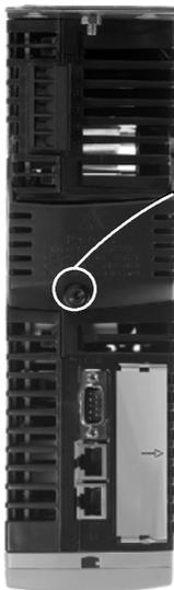
1. Allentare le viti di serraggio del coperchio del busbar per mostrare le sedi di montaggio.
