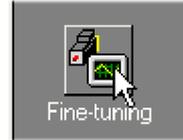
Das Fenster „Fine-tuning“ (Feinabstimmung) wird rechts im Bildschirm eingeblendet. Es enthält bereits einige Parameter, die vom Inbetriebnahmeassistenten berechnet wurden.
