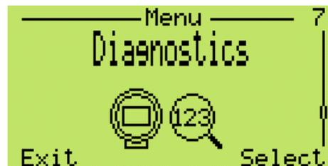
Questa sezione è dedicata all'osservazione dei messaggi di diagnostica che si riferiscono a variabile di processo, uscita in corrente, uscita percentuale, uscita scalata, pressione statica e temperatura del sensore. L'utilizzatore sarà guidato inoltre nella simulazione del loop test (generazione dei valori di 4 e 20mA e di un valore intermedio).
