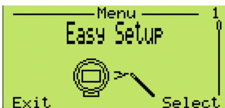
Questa sezione del menu permette una rapida parametrizzazione delle impostazioni di base del trasmettitore. L'utilizzatore sarà guidato nella selezione della lingua e delle unità ingegneristiche; nella definizione di tag, URV, LRV e funzione di trasferimento (lineare o quadratica); nell'impostazione dello smorzamento, del settaggio di zero (uscita a 4mA e PV a 0), oltre che delle opzioni riguardanti valori e modalità di visualizzazione delle informazioni.
