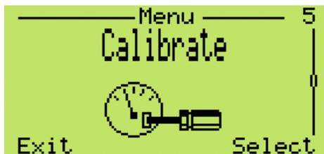
Questa sezione è dedicata alla calibrazione dello strumento. L'utilizzatore sarà guidato nella correzione del punto inferiore e superiore del campo di misura del sensore, e nell'aggiustaggio dei valori di 4–20mA. È inoltre possibile resettare i parametri impostati (e ritornare quindi ai valori di calibrazione e del segnale d'uscita stabiliti in fabbrica o dall'utilizzatore).
