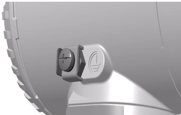
Figura 43: Terminale di messa a terra esterna sull'housing
