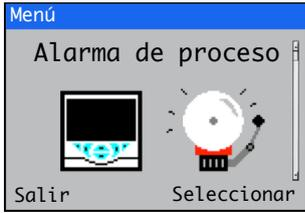
Sirve para configurar hasta 8 alarmas de proceso independientes.
