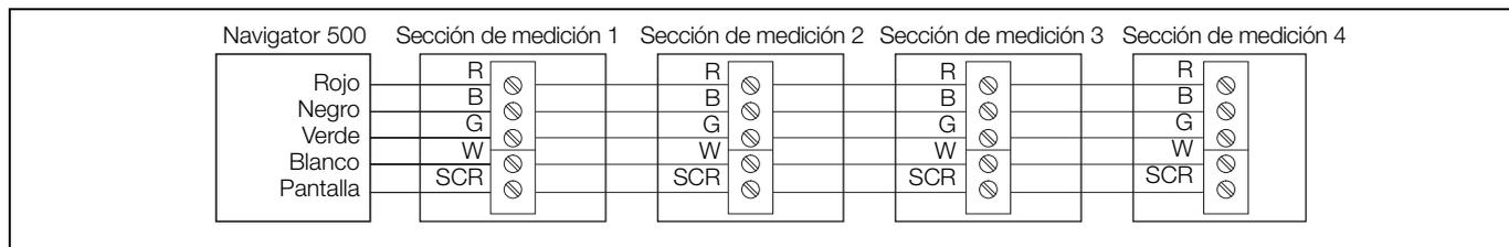
Fig. B.2 Conexiones en serie
