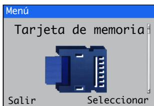
Se utiliza para activar o desactivar la tarjeta, seleccionar los datos de proceso que se van a registrar, introducir la selección de configuración de archivos y guardar los detalles, y formatear la tarjeta de memoria.
