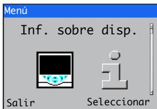
Muestra los detalles de solo lectura ajustados en fábrica para el transmisor y la sección o secciones de medición conectadas.
