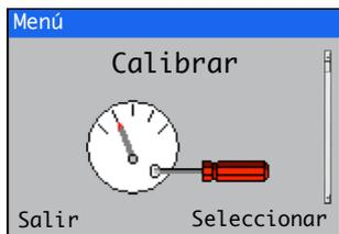
Se utiliza para calibrar la sección de medición, ajustar el valor de *Tiempo recuperación* y activar/desactivar la función *Retener salidas*.
