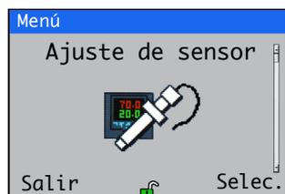
Se usa para establecer el tag identificador del sensor, el rango de funcionamiento, los parámetros de filtrado y el intervalo de limpieza.
