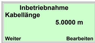
Eingabe der Signalkabellänge zwischen Messumformer und Messwertaufnehmer. Bei Geräten in kompakter Bauform ist 0,01 m einzugeben.
