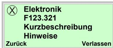
In der ersten Zeile wird der Bereich angezeigt, in dem der Fehler aufgetreten ist.
