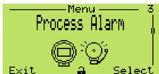
Ce menu permet de régler l'alarme de procédé. La structure du menu vous aidera à régler les limites de saturation et de déclenchement de l'alarme, ainsi qu'à personnaliser les messages d'alarme.
