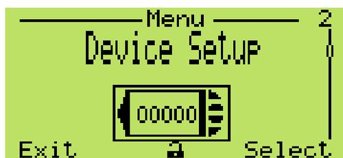
Ce menu permet le réglage des différentes fonctions relatives à l'afficheur lui-même. La structure du menu vous aidera à sélectionner, par exemple, la langue et le contraste d'affichage. Il est possible de choisir de manière détaillée ce qui doit s'afficher sur l'afficheur : une ou deux lignes, avec ou sans graphique. L'échelle d'affichage (limite haute et basse) peut être configurée à l'aide d'une section dédiée de ce sous-menu.
