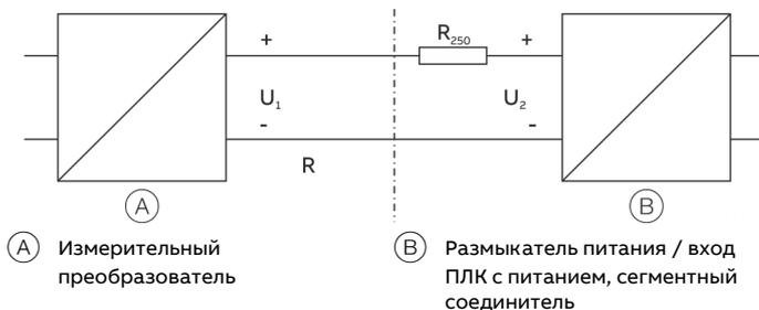
Рисунок 12. Сопротивление нагрузки HART
