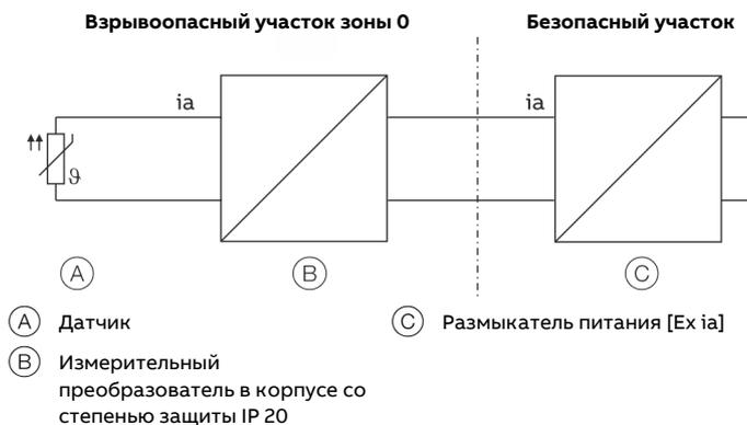
Рис. 2. Соединение в зоне 0 АTEX
