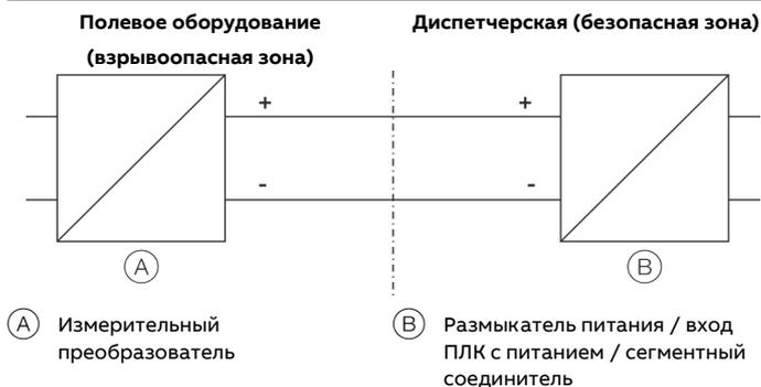
Рисунок 6. Свидетельство искробезопасности
