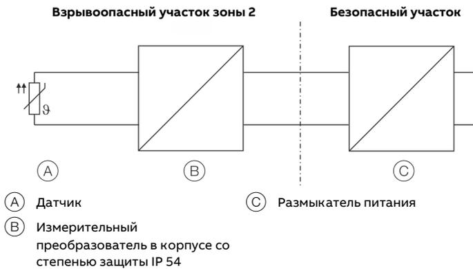
Рис. 5. Соединение в зоне 2 АTEX
